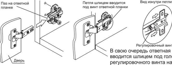
**Установка ответной планки для петли «быстрого монтажа» и установка дверей.** Ответную планку для петли следует устанавливать таким образом, чтобы стрелка на ней указывала на дверь. Мех-м быстрого монтажа должен «зацепами» зайти под корпус ответной планки, после чего можно будет легким нажатием защелкнуть петлю на ответной планке.
