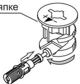
При демонтаже, для того чтобы вынуть дюбель эксцентриковой стяжки диам. 8 мм из отверстия на корпусе изделия необходимо слегка стукнуть дюбель по головке, после чего его можно будет легко вынуть из отверстия.
