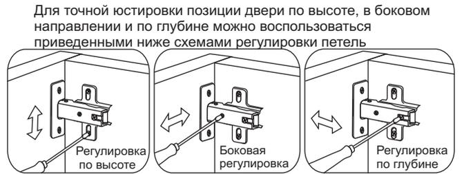
⚠ Устанавливая петли обращать внимание на угол - обязательно выровнять под  $90^{\circ}$ . Наколот под шурупы может не быть в зависимости от исполнения фасада. Шурупы вкрутить, не допуская перекоса петли.
